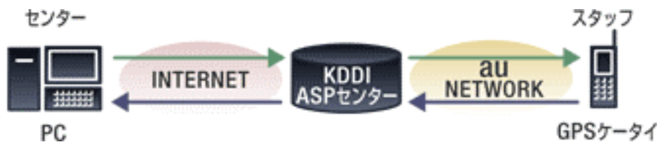
KDDI の GPSMAP [7] , 文献[22]の実験で使用 GPS (全地球測位システム) × GIS (地理情報システム)
